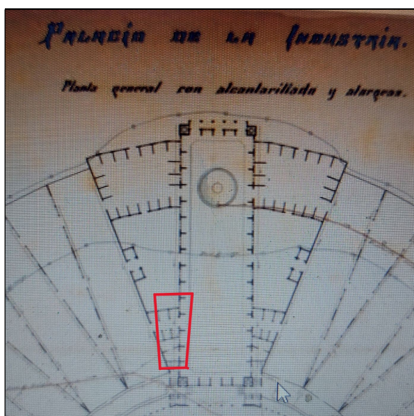
Planta General amb clavegueram de l Palau de la Indústria. En vermell possible zona localitzada.
